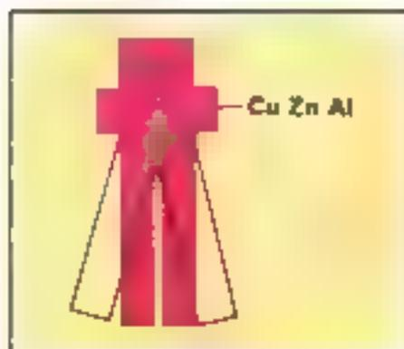
Fig. 2 Alliage à double effet (Souriau). À la température de fonctionnement (en noir sur la figure), les deux parties de la double tige s'écartent et le contact est séché. Lorsque celui-ci est refroidi, ces deux parties se rassemblent, le contact est à nouveau établi et l'ensemble de la pièce se réaligne dans un alliage de quatre-vingt-cinq pour cent.
